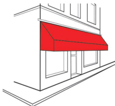
Mauvais exemple de store pour une devanture en feuillure
